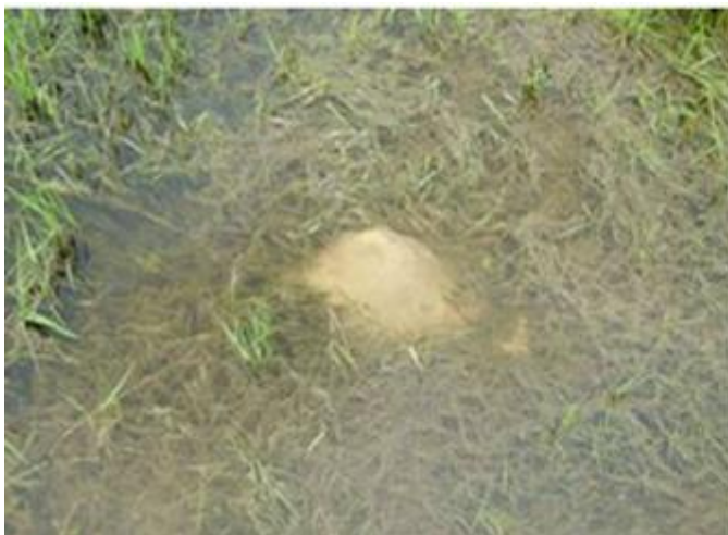
1. sz. kép: Alacsony vízhozamú törpebuzgár
